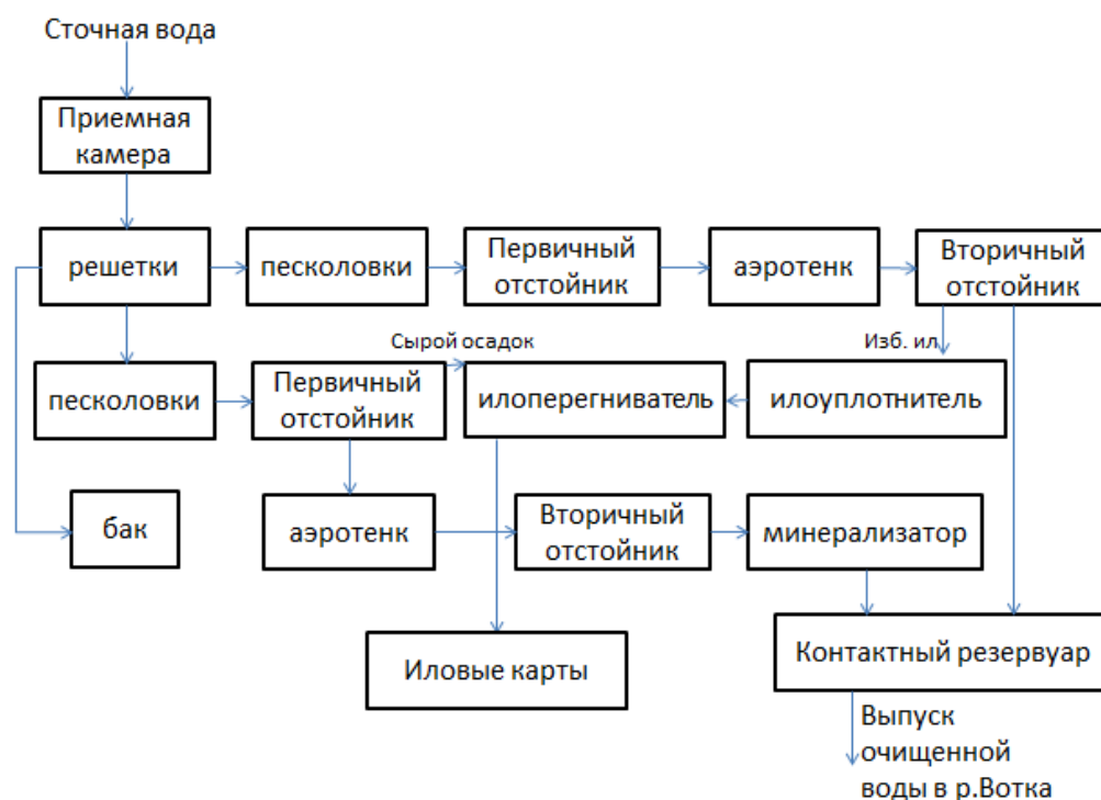
Рисунок 1 – Технологическая схема очистки сточных вод
