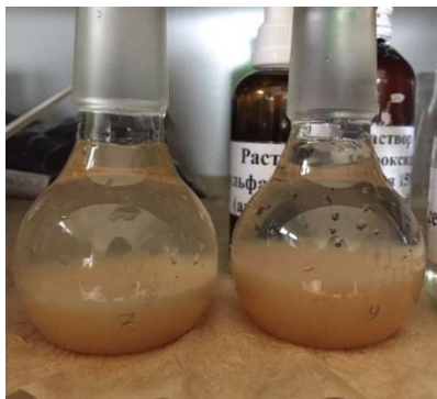
Рисунок 2 - Фиксация растворенного кислорода
