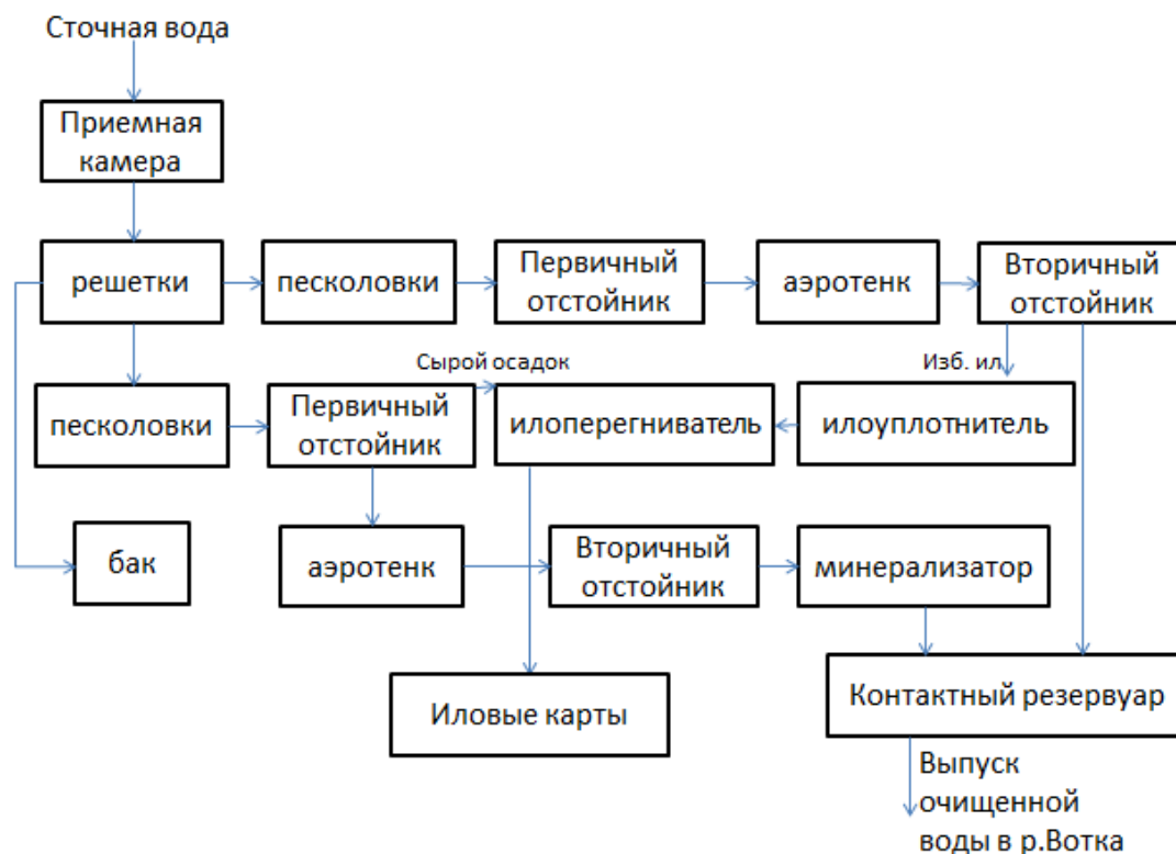
Рисунок 1 – Технологическая схема очистки сточных вод
