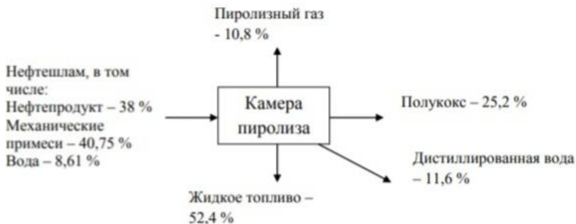
Рисунок 2 – Материальный баланс утилизации нефтешламных отходов на установке УТД-2
