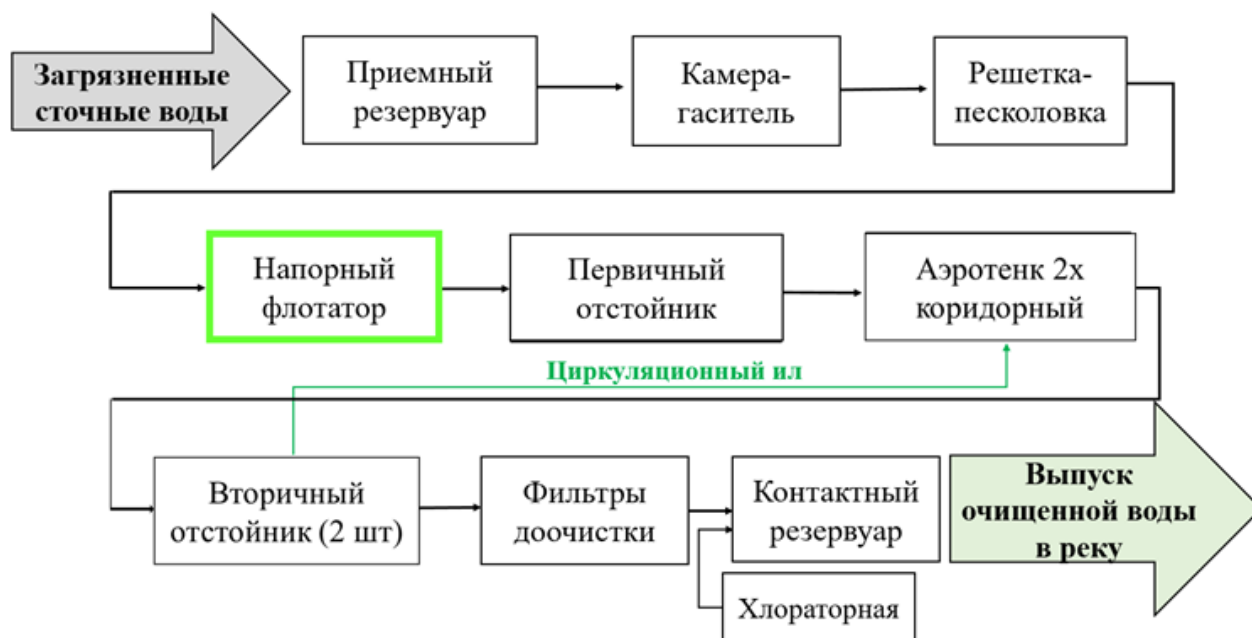
Рисунок 2 - Блок-схема очистных сооружений после усовершенствования
