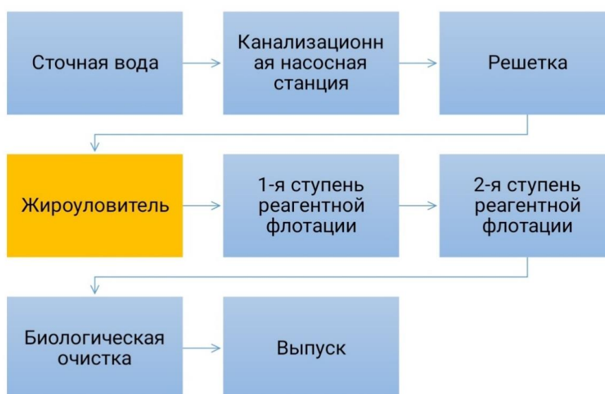
Рисунок 4 - Блок-схема очистных сооружений после усовершенствования
