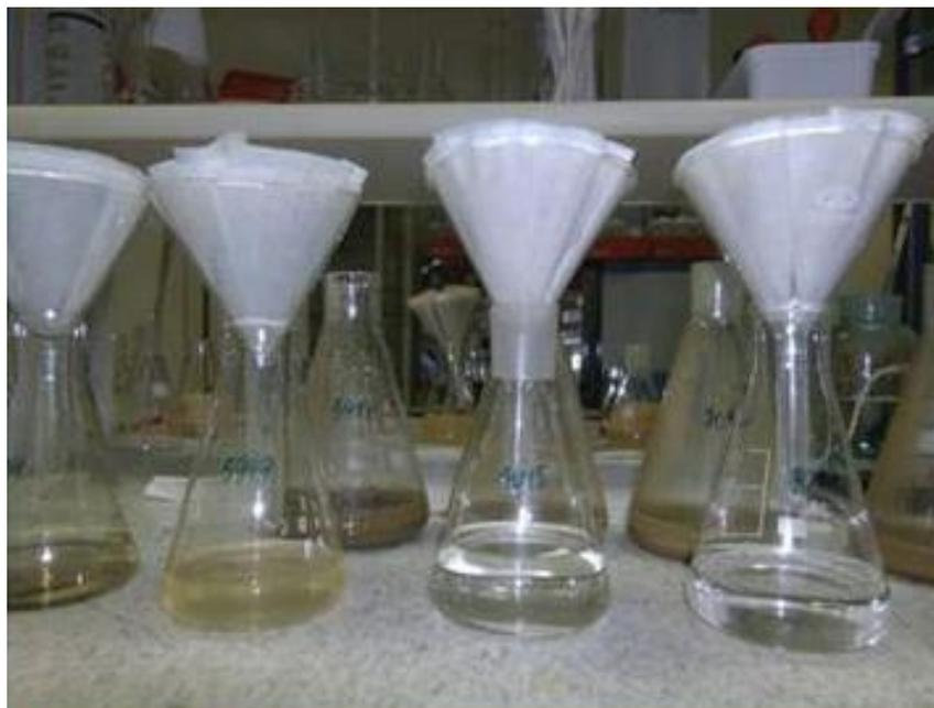
Рисунок 2 – Исследование сточных вод на концентрацию взвешенных веществ
