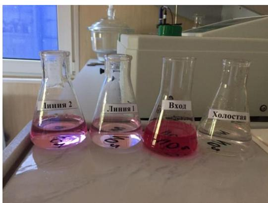
Рисунок 3 - Исследование сточной воды на концентрацию нитрит-иона - фосфаты, нитраты, сульфаты, хлориды, СПАВ, нефтепродукты [7]
