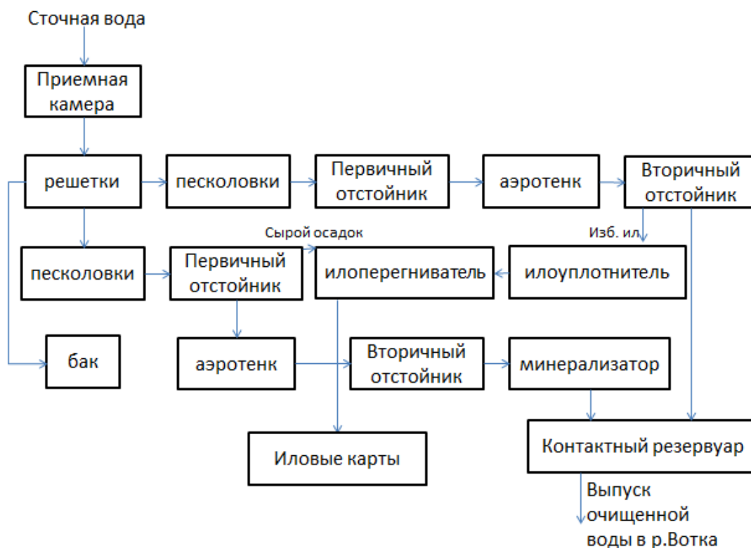
Рисунок 1 – Технологическая схема очистки сточных вод
